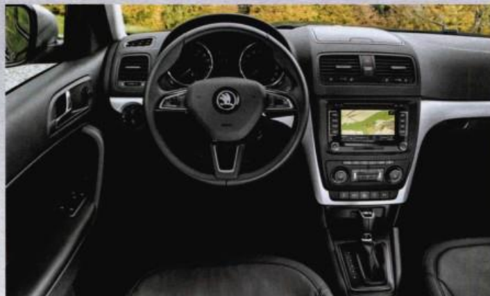
Руль новый, а проблема старая: приливы на ободе перекрывают часть шкал. В остальном салон не изменился, разве что баблдашик селектора DSG теперь другой
